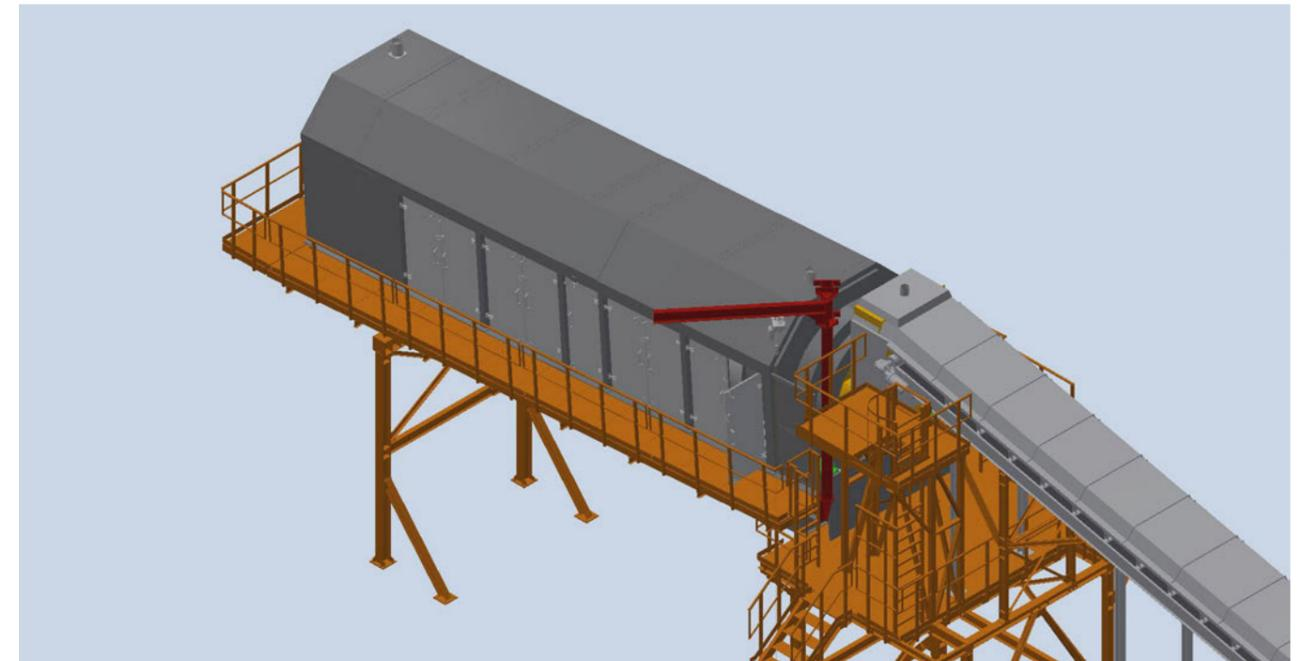
Il risultato positivo raggiunto è stato facilitato dal criterio di costruzione generoso in termini di spessori dei profilati che costituiscono il macchinario, che hanno potuto superare le verifiche meccaniche senza necessitare di particolari modifiche al corpo macchina.
