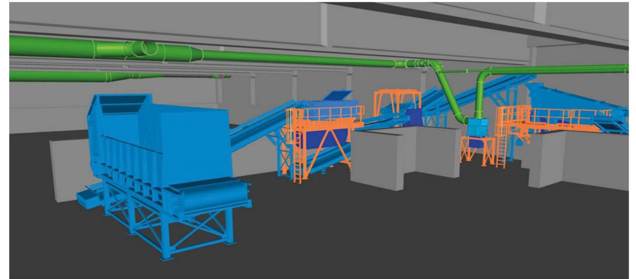
La linea di raffinazione è strutturata per selezionare la frazione estranea, il compost e lo strutturante che viene riciclato in ingresso. L'impianto prevede anche il revamping dell'aspirazione dei locali e della zona di trattamento arie con scrubber e biofiltro.
