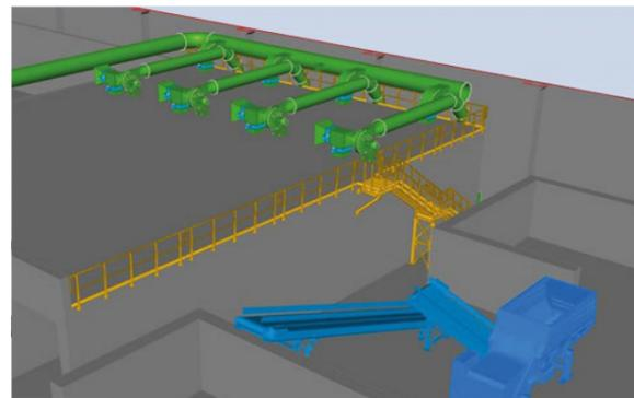
Per limitare gli impatti odorigeni si prevede l'installazione di 2 scrubber nuovi a doppio stadio e con la possibilità di usare reagenti acido-base. Dopo gli scrubber vi è il sistema biofiltro, dove si è studiato, grazie a delle simulazioni con programmi specializzati, una distribuzione ottimale delle tubazioni che convogliano l'aria al plenum del biofiltro.
