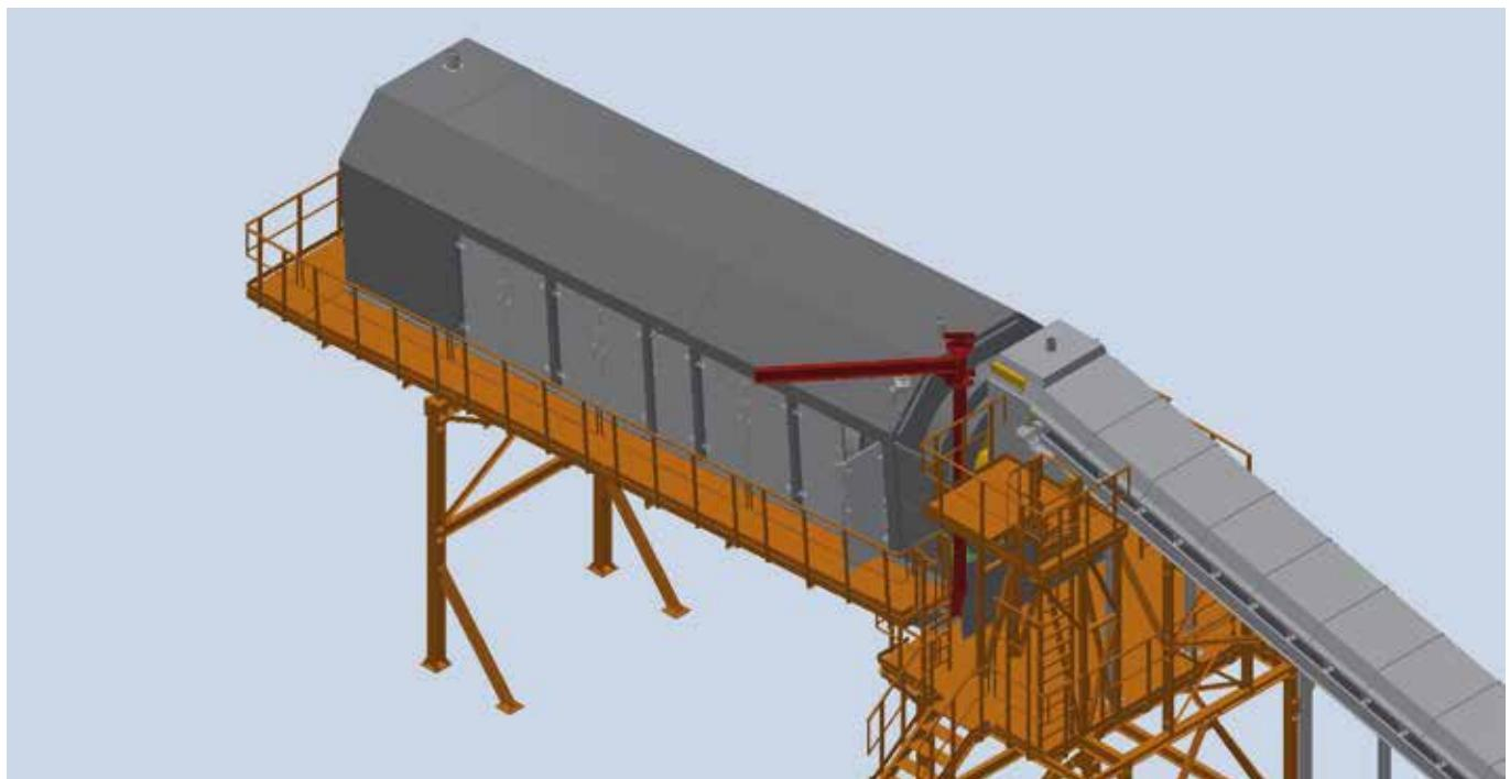
**Il risultato positivo raggiunto è stato facilitato dal criterio di costruzione generoso in termini di spessori dei profilati che costituiscono il macchinario, che hanno potuto superare le verifiche meccaniche senza necessitare di particolari modifiche al corpo macchina.**
