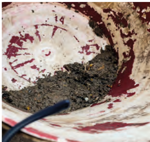
Digestato, materiale in uscita Reattori Digested, material outgoing the reactors
